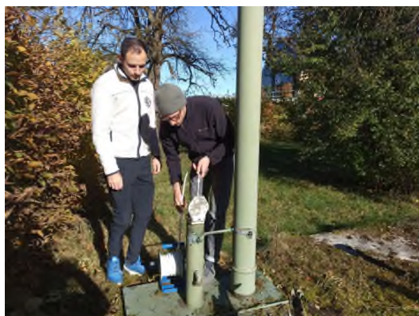
Abbildung 1: An einem weißen Band lässt Ludwig Setzwein ein Lichtlot hinunter in den Brunnen-schacht. Auf diese Weise kann er messen, in welcher Tiefe das Grundwasser zu finden ist. Gemeinsam mit Alexander Wartner (l.) forscht Setzwein nach den Ursachen für den sinkenden Grundwasserspiegel der Seeoner Seen. Beide sind Studenten und wollen ihre Forschungsergebnisse als Grundlage für ihre Masterarbeiten nutzen. Foto: Wasserwirtschaftsamt Traunstein
