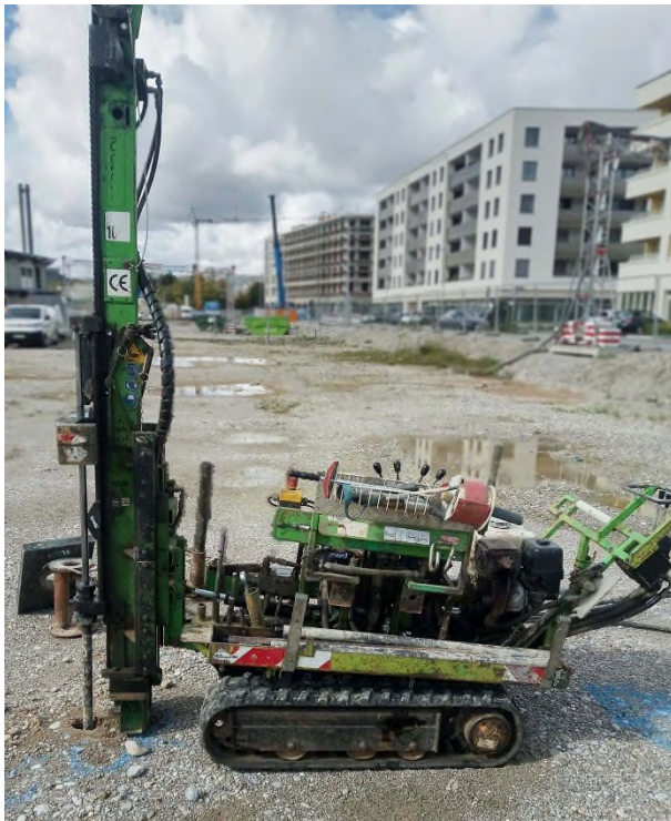
Abb. 1: Mit einem kleinen Raupengerät wie diesem werden Sondierungen in schwer zugänglichem Gelände durchgeführt.
