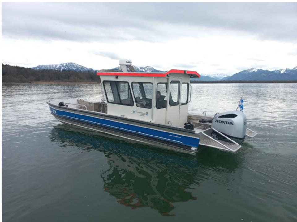
Abbildung 2: Das neue, noch namenlose Transportboot ist für eine Last bis zu zwei Tonnen gebaut, verfügt über einen leistungsgerechten Außenborder, ist 9,10 Meter lang und 2,55 Meter breit. Es löst die „Elisabeth“ ab, die 38 Jahre lang auf dem Chiemsee im Einsatz war.
