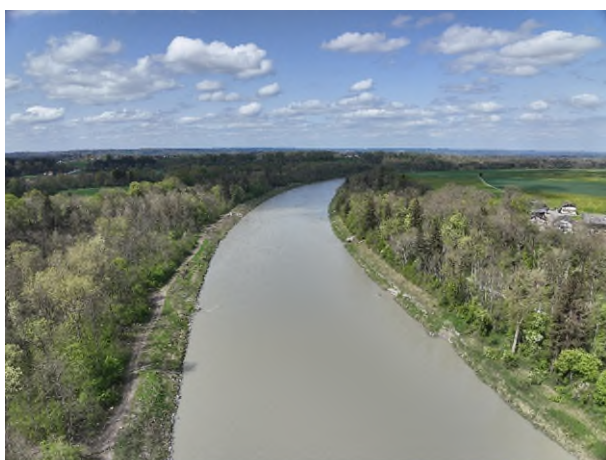
Abbildung 1: Das Bild zeigt die Salzach stromabwärts. Links, auf der bayerischen Seite des Flusses, werden die Uferbausteine entfernt. Auf einer Länge von drei Kilometern kann die Salzach dann frei fließen. Foto: Wasserwirtschaftsamt Traunstein
