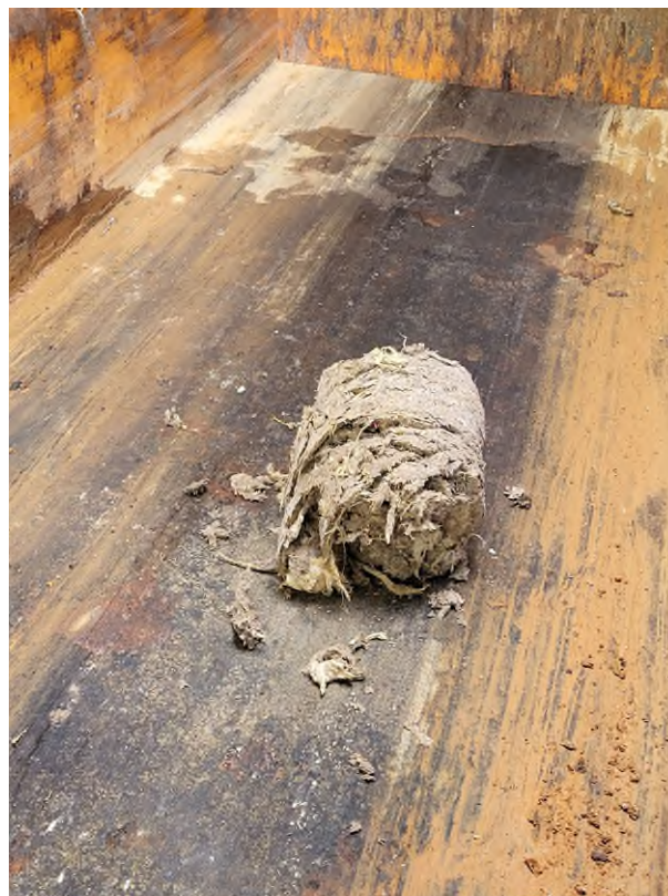
Abbildung 5: Der von den Rechen aussortierte Abfall wird gespült, gepresst und schließlich zur Müllverbrennung gefahren. Foto: Wasserwirtschaftsamt Traunstein
