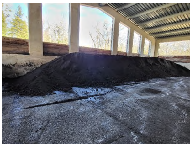
Abbildung 2: Der Klärschlamm wird mit Hilfe einer Zentrifuge entwässert. Es verbleibt eine Restfeuchte von etwa 70 Prozent. Foto: Wasserwirtschaftsamt Traunstein
