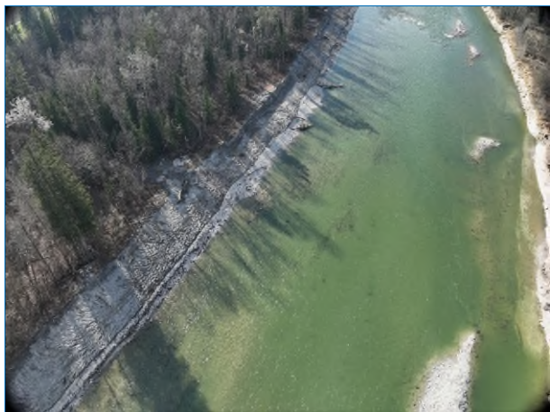
Abbildung 1: Die Ufersicherung entlang der Salzach ist zwischen dem Kraftwerk Lebenau und der Ortschaft Osing ausgebaut. Der Fluss kann sich jetzt in die Breite entwickeln. Foto: Wasserwirtschaftsamt Traunstein
